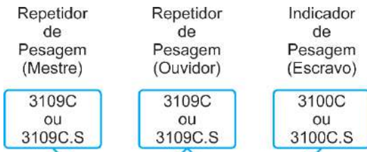
Figura 7 – Repetidor de Pesagem como mestre da rede e ouvidor da comunicação com Indicador de Pesagem
