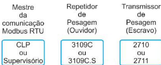
Figura 11 – Repetidor de Pesagem como ouvidor da comunicação ente dispositivo mestre com Transmissor de Pesagem
