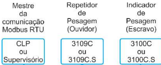
Figura 8 – Repetidor de Pesagem como ouvidor da comunicação entre dispositivo mestre e Indicador de Pesagem
