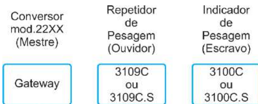
Figura 8 – Repetidor de Pesagem como ouvidor da comunicação entre dispositivo mestre e Indicador de Pesagem
