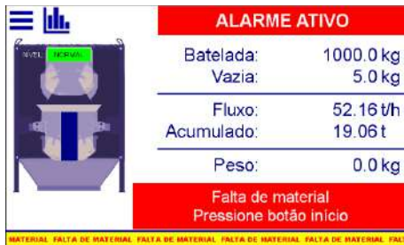
Figura 26 – Alarme de falta de material ativo
