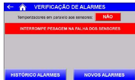
Figura 32 – Tela de Verificação de Alarmes
