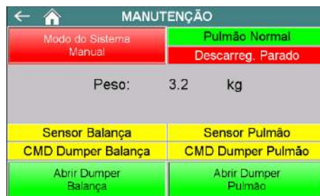
Figura 7 – Tela Manutenção (comandos e sensores acionados)
