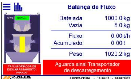
Figura 53 – Indicação sem o sinal do Transportador de descarregamento durante ciclo de pesagem
