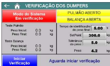
Figura 12 – Tela Verificação dos Dumpers (Iniciar verificação)
