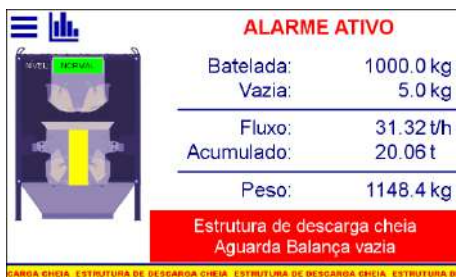
Figura 28 - Alarme Estrutura de descarga cheia ativo (não identificado decréscimo de peso na balança)
