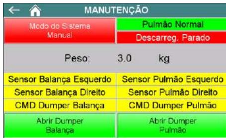
Figura 10 – Tela Manutenção (comandos e sensores acionados)
