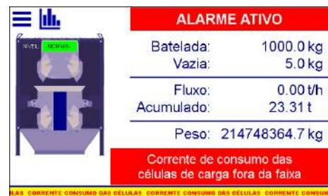
Figura 50 – Indicação da corrente de consumo das células de carga fora da faixa
