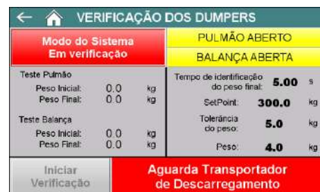
Figura 14 – Tela Verificação dos Dumpers (Aguarda sinal do transportador de descarregamento)
