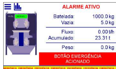
Figura 51 – Botão de emergência acionado
