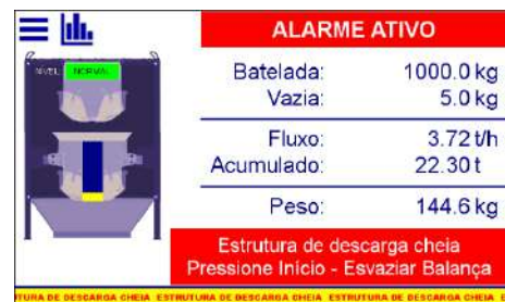
Figura 30 – Alarme Estrutura de descarga cheia (retorno de material)
