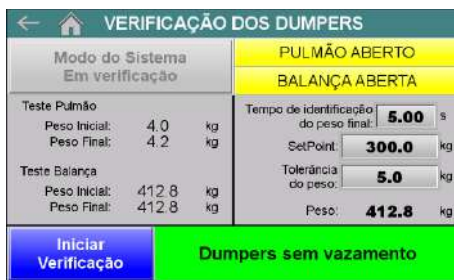
Figura 17 – Mensagem Dumpers sem vazamento
