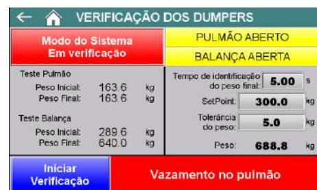
Figura 15 – Mensagem de vazamento no pulmão
