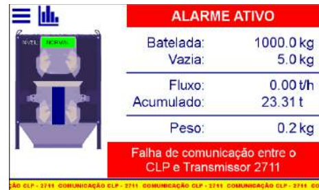
Figura 49 – Indicação da falha de comunicação entre o Transmissor 2711 e o controlador
