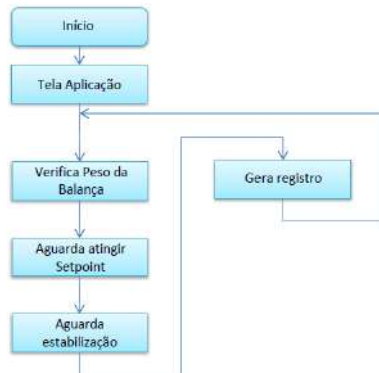
Figura 20 – Fluxograma de operação da aplicação
