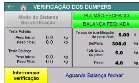
Figura 13 – Tela Verificação dos Dumpers (Aguarda atingir setpoint)
