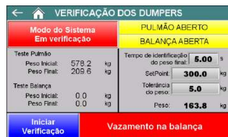
Figura 16 – Mensagem de vazamento na balança
