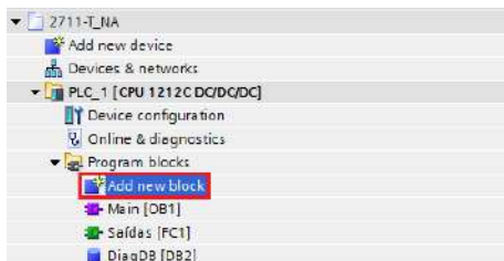
Figura 107 – Adicionar novo bloco
