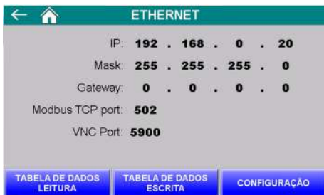
Figura 64 – Tela de visualização dos parâmetros da porta Ethernet TCP/IP
