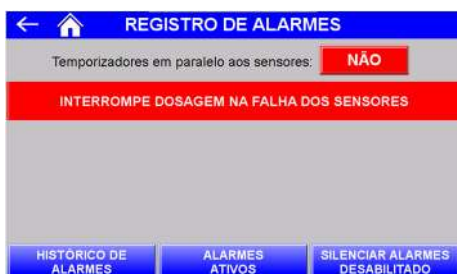
Figura 27 – Interromper dosagem na falha dos sensores ativado
