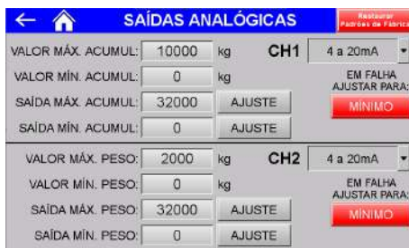
Figura 143 – Configuração dos parâmetros das saída analógicas
