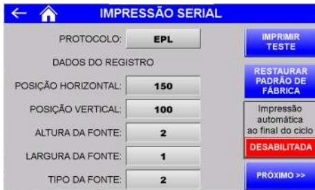
Figura 32 – EPL Tela 1 de configuração dos parâmetros de impressão
