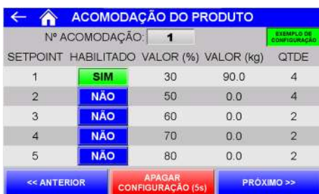
Figura 11 – Exemplo de configuração da receita de acomodação
