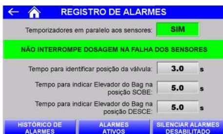
Figura 28 – Interromper dosagem na falha dos sensores desativado
