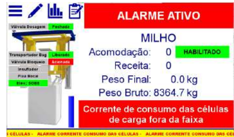
Figura 54 – Mensagem de falha de corrente de consumo das células de carga fora da faixa configurada
