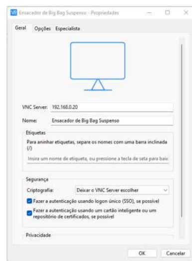
Figura 67 – Janela de configuração do endereço IP da IHM
