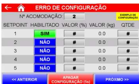
Figura 10 – Erro na configuração dos parâmetros da receita de acomodação
