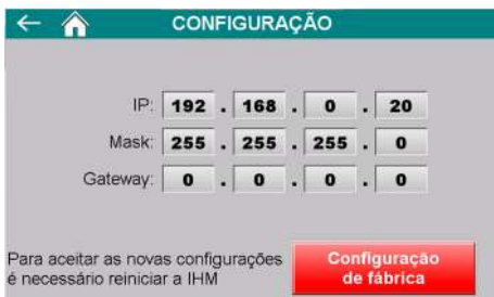
Figura 65 – Tela de configuração dos parâmetros da porta Ethernet TCP/IP
