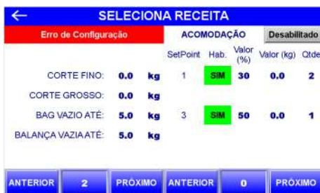
Figura 47 – Indicação de erro de configuração da receita de dosagem
