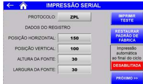
Figura 34 – ZPL Tela 1 de configuração dos parâmetros de impressão
