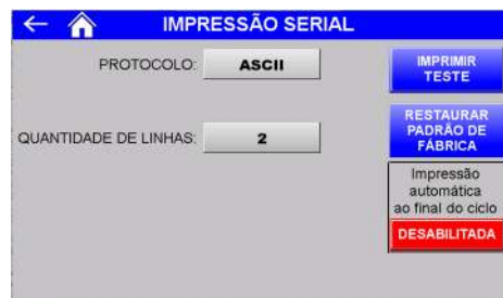
Figura 36 – ASCII Tela de configuração dos parâmetros de impressão
