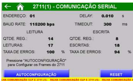
Figura 53 – Tela de comunicação serial com o Transmissor de Pesagem
