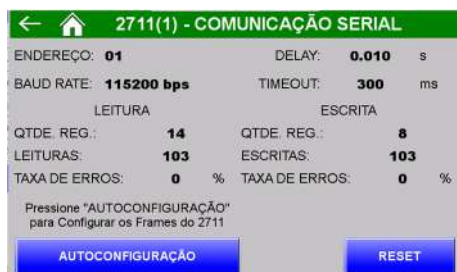
Figura 147 – Tela comunicação serial 2711 Pesagem modelo Ex
