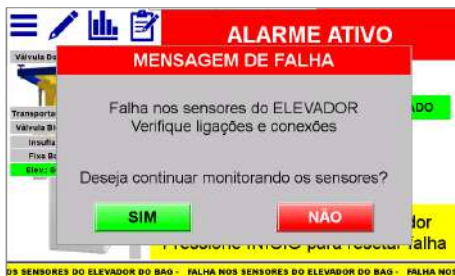
Figura 58 – Pop-up falha nos sensores do ELEVADOR
