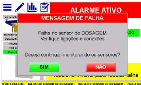
Figura 57 – Pop-up falha no sensor de Dosagem
