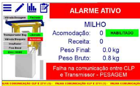
Figura 51 – Mensagem de falha de comunicação entre o CLP e o Transmissor de Pesagem 2711
