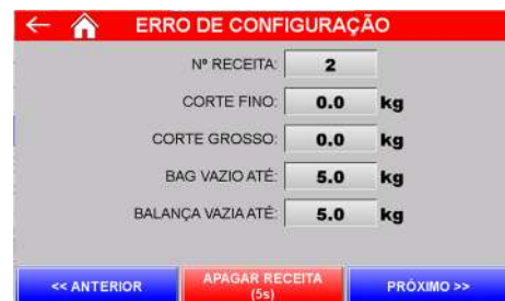
Figura 8 – Erro de configuração dos parâmetros da receita de dosagem
