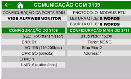
Figura 148 – Tela comunicação com Repetidor de Pesagem 3109
