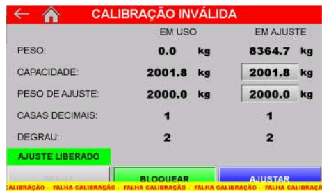
Figura 137 – Mensagem de ajuste inválido nas telas PARÂMETROS e AJUSTE
