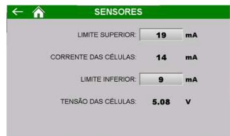
Figura 55 – Tela de configuração da faixa de trabalho da corrente de consumo das células de carga conectadas
