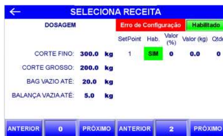
Figura 48 – Indicação de erro de configuração da receita de acomodação
