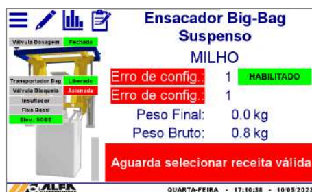
Figura 49 - Indicação de erro de configuração na receita de dosagem e/ou de acomodação
