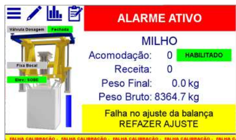
Figura 138 – Mensagem de falha na calibração
