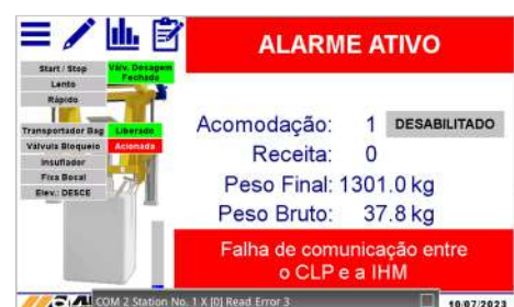
Figura 56 – Mensagem de falha de comunicação entre o CLP e a IHM
