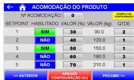
Figura 9 – Tela de configuração dos parâmetros do ciclo de acomodação
