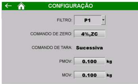
Figura 139 – Configuração dos bits de sinalização do Transmissor de Pesagem
