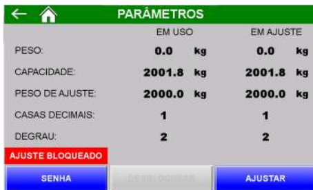
Figura 135 – Tela de configuração dos parâmetros de ajuste
