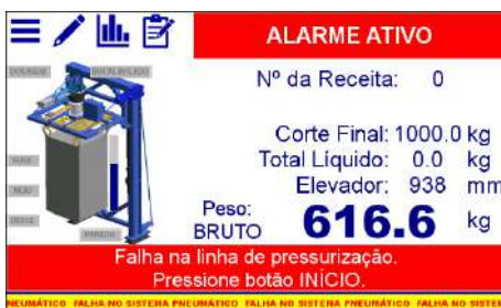
Figura 59 – Falha no sensor de pressão
