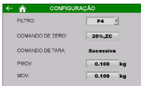
Figura 157 – Configuração dos bits de sinalização do Transmissor de Pesagem
