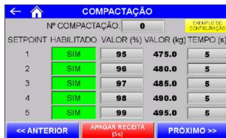
Figura 10 – Tela de configuração dos parâmetros do ciclo de compactação
