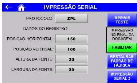
Figura 31 – ZPL Tela 1 de configuração dos parâmetros de impressão serial
