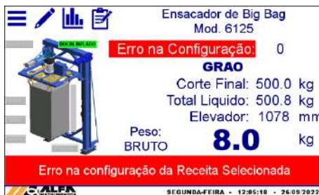
Figura 45 - Indicação de erro de configuração na receita de dosagem e/ou de compactação
