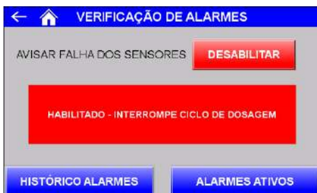
Figura 19 – Avisar falha dos sensores ativado
