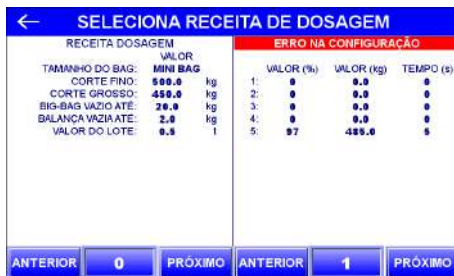
Figura 44 – Indicação de erro na configuração da receita de compactação
