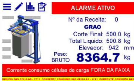
Figura 54 – Mensagem de falha de corrente de consumo das células de carga fora da faixa configurada (Transmissor de Pesagem)
