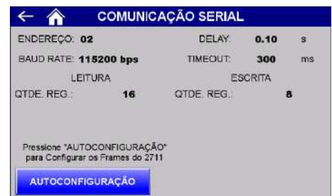
Figura 53 – Tela de comunicação serial com o Transmissor de Pesagem
