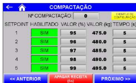
Figura 12 – Exemplo de configuração da receita de compactação
