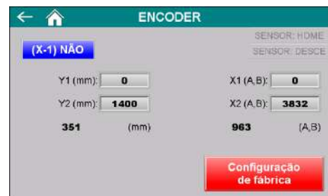
Figura 47 – Tela de configuração do Encoder
