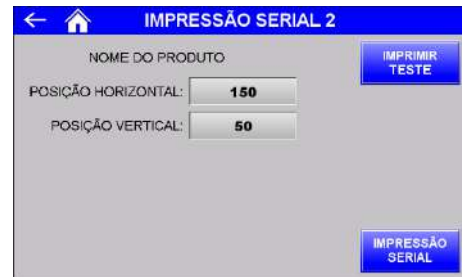
Figura 32 – ZPL Tela 2 de configuração dos parâmetros de impressão serial
