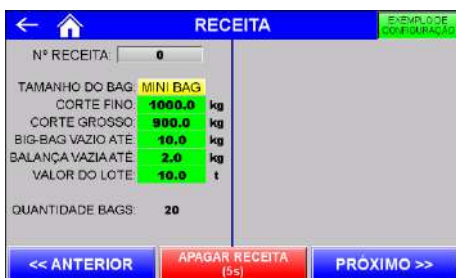
Figura 9 – Exemplo de configuração da receita de dosagem
