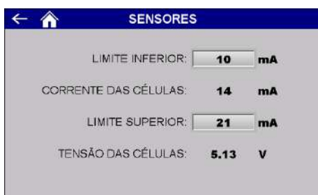
Figura 160 – Tela de configuração da faixa de trabalho da corrente de consumo das células de carga conectadas
