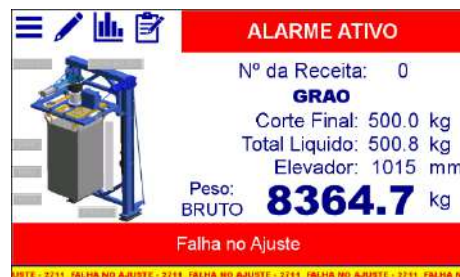
Figura 151 – Mensagem de falha na calibração
