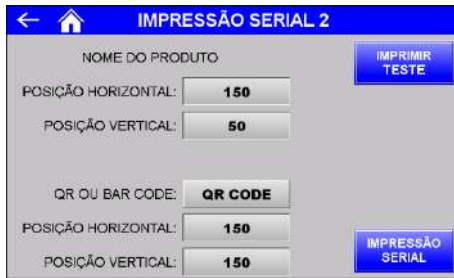
Figura 30 – EPL Tela 2 de configuração dos parâmetros de impressão serial
