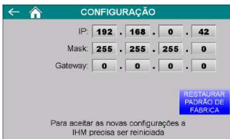
Figura 67 – Tela de configuração dos parâmetros da porta Ethernet TCP/IP
