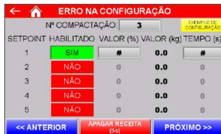
Figura 11 – Erro na configuração dos parâmetros da receita de compactação
