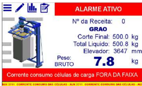
Figura 55 – Mensagem de falha de corrente de consumo das células de carga fora da faixa (Transmissor de Pesagem – Elevador)
