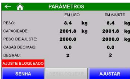
Figura 148 – Tela de configuração dos parâmetros de ajuste
