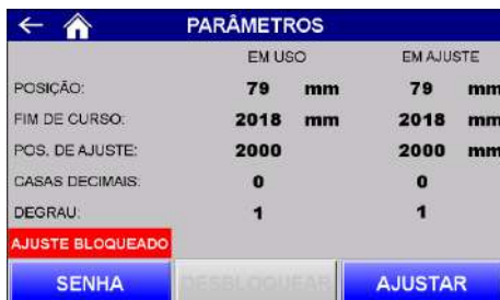
Figura 153 – Tela de configuração dos parâmetros de ajuste
