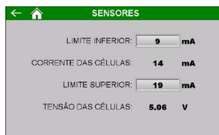
Figura 159 – Tela de configuração da faixa de trabalho da corrente de consumo das células de carga conectadas
