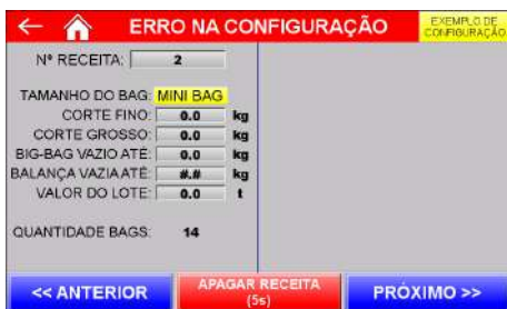
Figura 8 – Erro na configuração dos parâmetros da receita de dosagem
