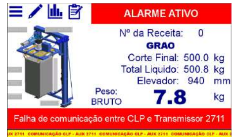
Figura 51 – Mensagem de falha de comunicação entre o CLP e Transmissor de Pesagem 2711 – Elevador
