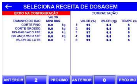
Figura 43 – Indicação de erro na configuração da receita de dosagem
