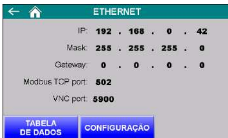
Figura 66 – Tela de visualização dos parâmetros da porta Ethernet TCP/IP
