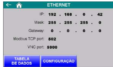
Figura 142 – Tela de visualização dos parâmetros da porta Ethernet TCP/IP
