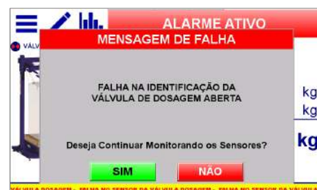
Figura 11 – Mensagem de falha dos sensores
