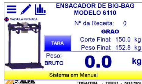
Figura 40 – Sistema em modo MANUAL (válvula de dosagem)
