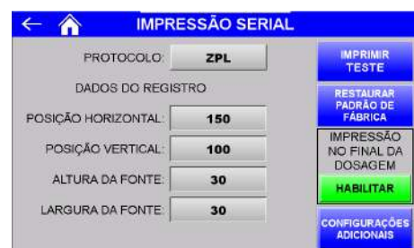
Figura 21 – Configuração dos parâmetros de impressão serial ZPL
