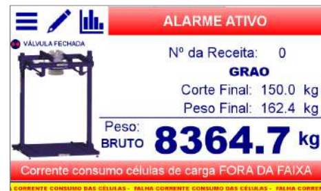
Figura 34 – Corrente de consumo das células de carga fora da faixa
