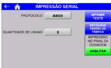
Figura 23 – Configuração dos parâmetros de impressão serial ASCII
