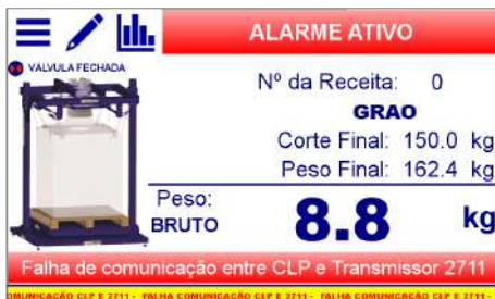
Figura 32 – Falha de comunicação entre o Transmissor 2711 e o controlador
