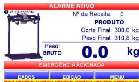
Figura 36 – Botão de emergência acionado
