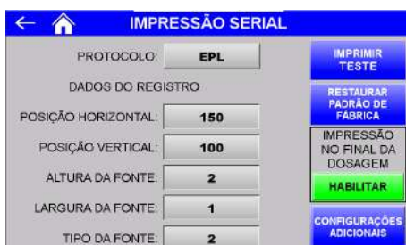
Figura 19 – Configuração dos parâmetros de impressão serial EPL
