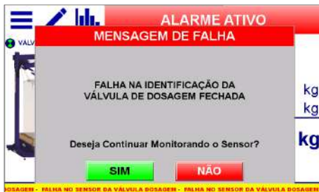
Figura 31 – Falha no sensor de dosagem
